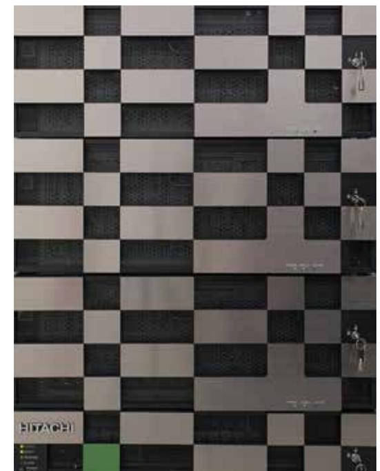
Abb. 2 (rechts): VSP G370 (unten) mit Disk-Chassis für je 60 3.5" Festplatten (10 TB)
